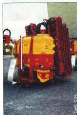
Le Gekko offre 1800 litres de capacité pour un poids à vide de 1750 kilos.
